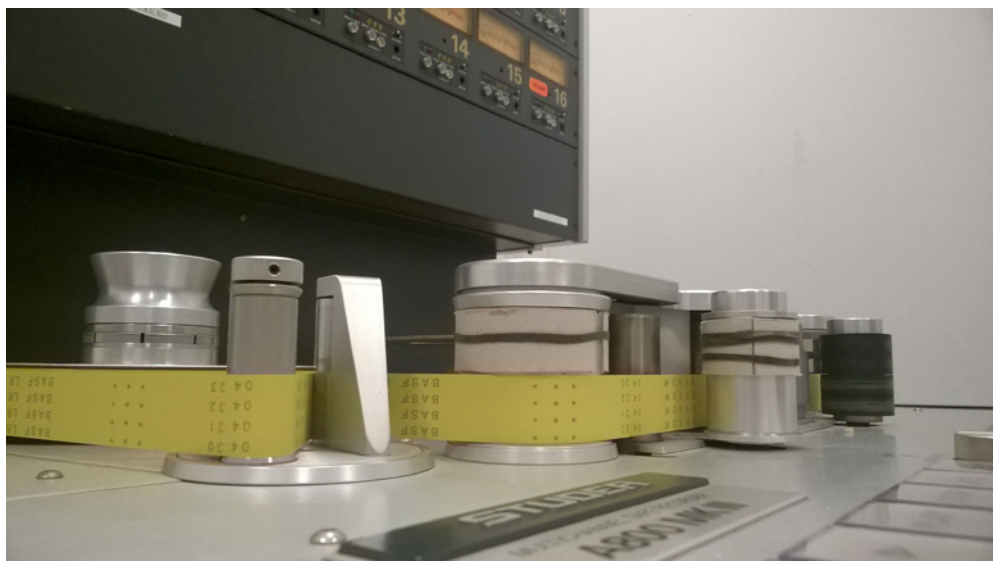
Fot. 2. Doraźne rozwiązanie problemu braku odpowiedniego sprzętu do odtwarzania określonych nagrań. Zdjęcie ilustruje odtworzenie taśmy Studia Eksperymentalnego na magnetofonie 16-śladowym z torem przesuwu zwężonym za pomocą prowizorycznie wykonanych rolek. Fot. Anna Rutkowska, 2017.
